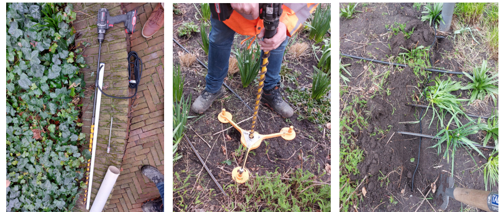
Figuur 8 Installatie van de bodemvochtsensoren bij de beuk (links) en in de groenstrook (midden en rechts) in maart 2024.
